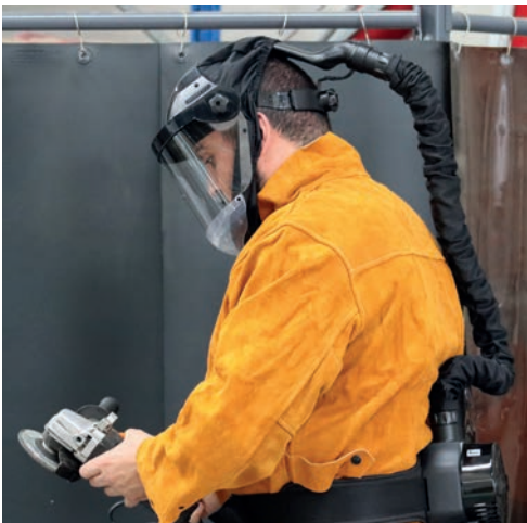
El protector facial para esmerinado DC-Guard con motoventilador DACAiR cumple con la legislación de la Unión Europea 2016/425 y con las normas de armonización EN166 3 9 B y CE EN 12941, clase TH2
