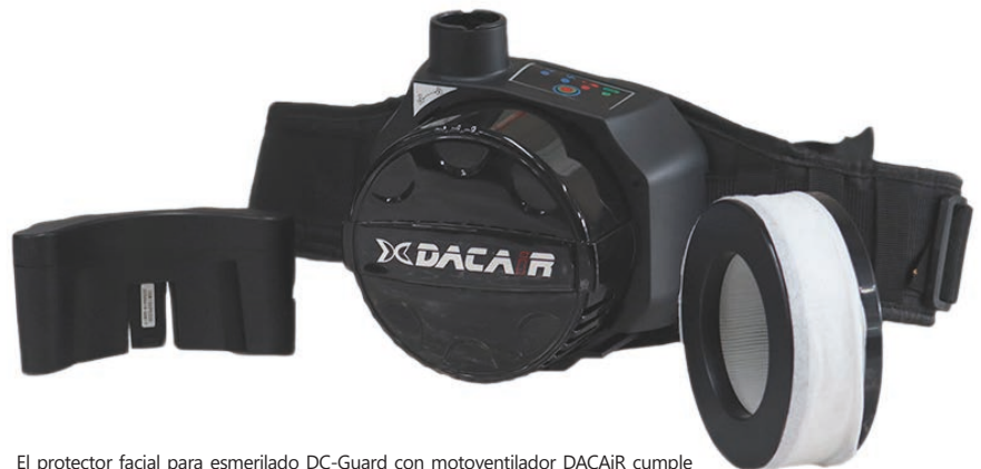
El protector facial para esmerinado DC-Guard con motoventilador DACAiR cumple con la legislación de la Unión Europea 2016/425 y con las normas de armonización EN166 3 9 B y CE EN 12941, clase TH2
