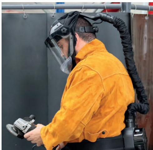
L'écran pare-visage DC-Guard avec motoventilateur DACAiR est conforme à la législation de l'Union Européenne 2016/425 et est certifié selon les normes EN166 3 9 B et CE EN 12941, classe TH2
